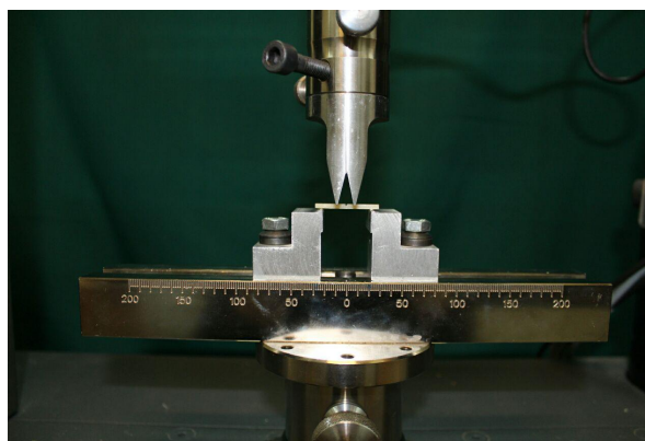
شکل ۱- ب: نحوه قرارگیری نمونه در دستگاه تست فشار
