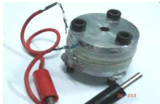
شکل ۱۰- شماتیک باتری دو قطبی ۷/۵ ولتی مدل آزمایشگاهی.
