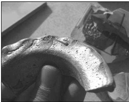
شکل ۸ - سطح زرین فام فلزی در کاهش جسم لعاب.
