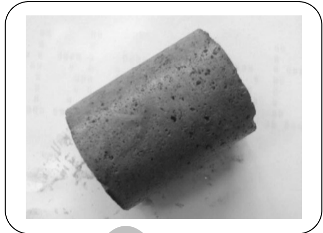
شکل ۱۷- نمای جانبی مغزه شماره ۶ بعد از عملیات تزریق.
