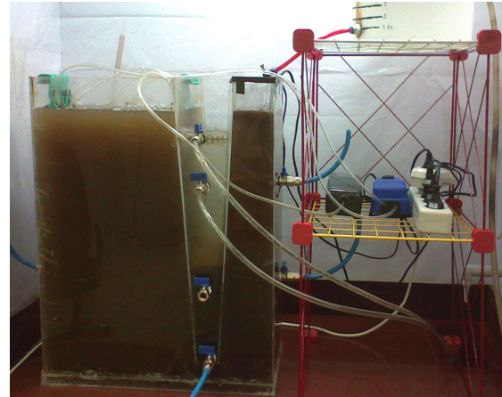
شکل ۲- تصویری از پایلوت USBF در انتهای دوره راه‌اندازی با جریان پیوسته.
