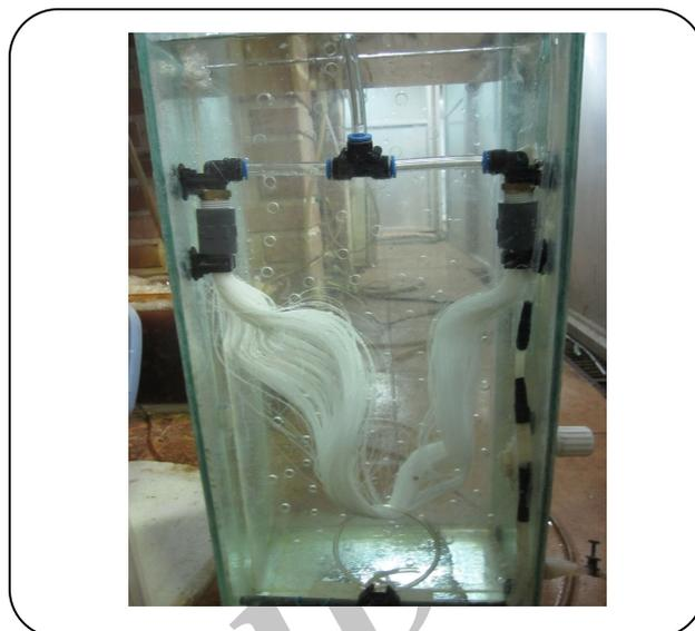
شکل ۲- نمایی از راکتور و غشا.
