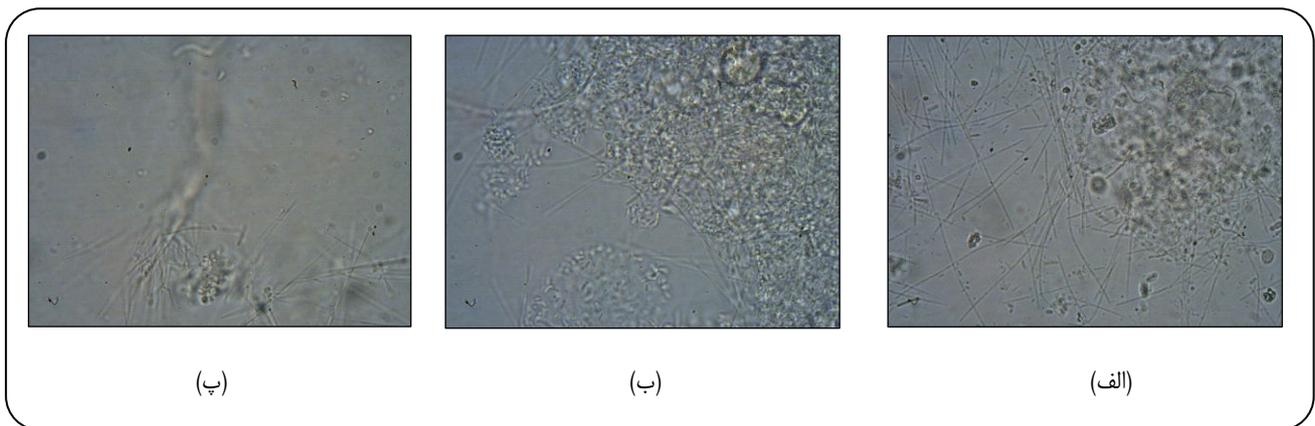
شکل ۱۰- (الف) نمایی از میکروارگانیسم‌های رشد یافته درون راکتور زیست فیلمی با بستر متحرک معمولی (ب) نمایی از میکروارگانیسم‌های رشد یافته درون راکتور زیستی حاوی غشا (پ) نمایی از میکروارگانیسم‌های رشد یافته درون راکتور زیستی حاوی غشا (پ) نمایی از میکروارگانیسم‌های رشد یافته بر روی زیست فیلم.
