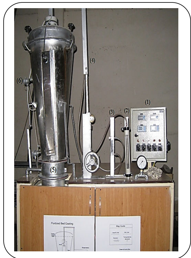
شکل ۲- تصویری از دستگاه. (۱) تابلو برق. (۲) روتامتر هوا. (۳) روتامتر مایع. (۴) میله بالابرنده نازل. (۵) بستر سیال. (۶) حسگر دما.
