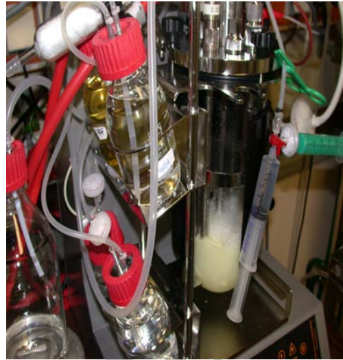
شکل ۴- راکتور زیستی در حال تولید رامنولپید و کف به وجود آمده در آن.
