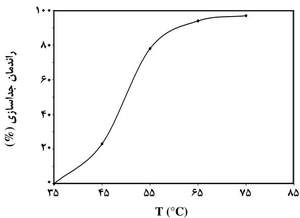
شکل ۲- اثر دمای حباب آب بر بازده جداسازی آب DMAZ+ از پساب.
