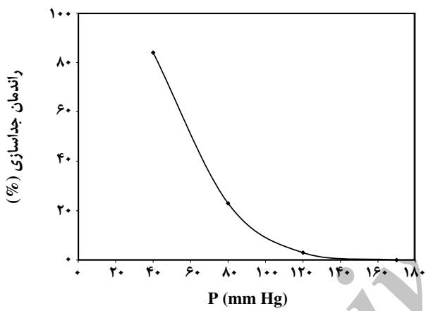
شکل ۳- اثر فشار سامانه بر بازده جداسازی آب و DMAZ از پساب در دمای  $56^{\circ}\text{C}$ .
