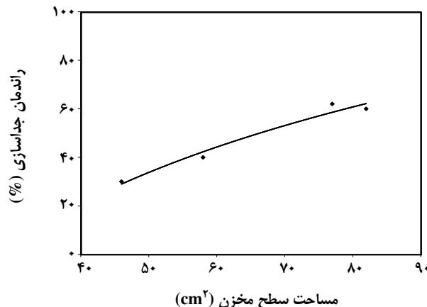
شکل ۵ - اثر تغییر سطح مقطع ظرف خوارک بر بازده جداسازی آب و DMAZ از پساب.
