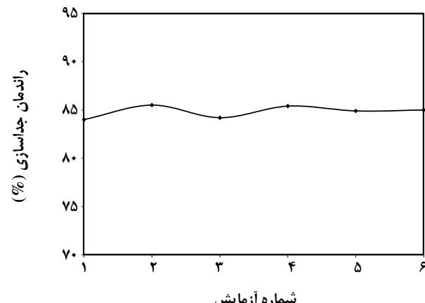
در شرایط بهینه (دما =  $60^{\circ}\text{C}$  درجه سلسیوس، خلا مطلق حاکم بر سامانه، سرعت چرخش ظرف خوراک =  $40\text{mmHg}$ ، سرعت چرخش ظرف خوراک =  $120\text{rpm}$ ، سطح مقطع ظرف خوراک =  $67\text{cm}^2$  و شدت خلا =  $29/7\text{L/min}$ ).
