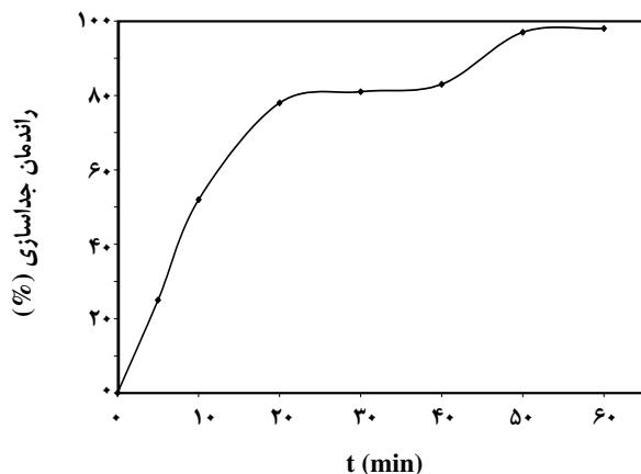
شکل ۸ - تغییرهای بازده جداسازی آب و DMAZ از پساب با زمان در شرایط بهینه (دما =  $60^{\circ}\text{C}$  درجه سلسیوس، خلا مطلق حاکم بر سامانه، سرعت چرخش ظرف خوراک =  $40\text{mmHg}$ ، سرعت چرخش ظرف خوراک =  $120\text{rpm}$ ، سطح مقطع ظرف خوراک =  $67\text{cm}^2$  و شدت خلا =  $29/7\text{L/min}$ ).
