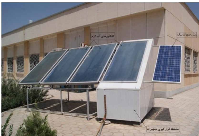
شکل ۲- تصویری از دستگاه ترکیبی آب گرم کن/آب شیرین کن خورشیدی.
