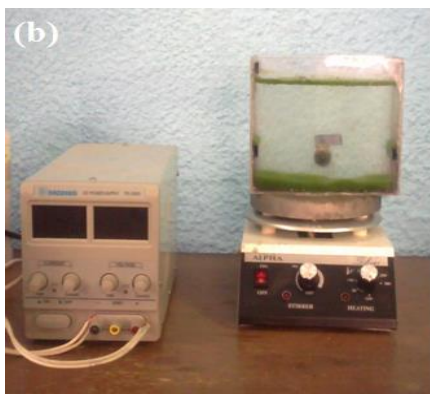
شکل ۳- سامانه انعقاد - شناورسازی الکتریکی؛ پیش (a) و پس (b) از جداسازی میکروجلبکها (منبع تغذیه DC، محفظه پلکسی گلاس، الکترودهای آلومینیومی، ۴- همزن مغناطیسی).
