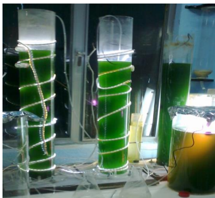
شکل ۲- راکتور زیستی نوری مورد استفاده برای کشت میکروجلبک.
