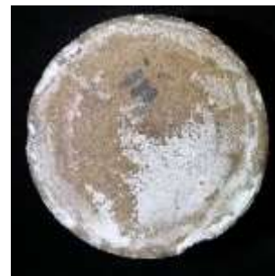
شکل ۶ - تصویر ورودی نمونه سنگ در پایان آزمایش.
