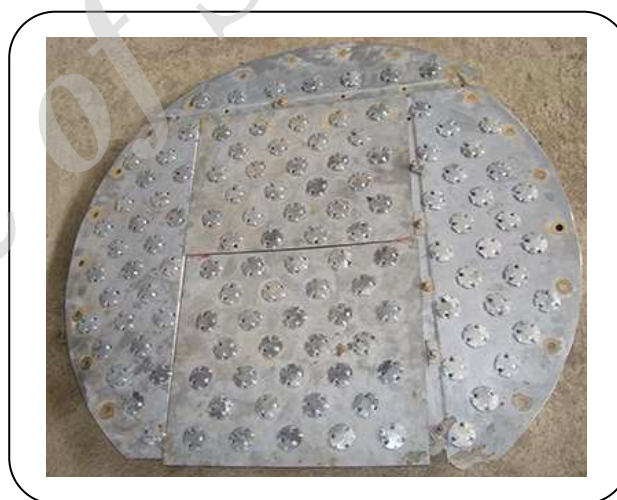
شکل ۲- تصویر سینی دریچه‌ای مورد آزمایش قرار گرفته.
