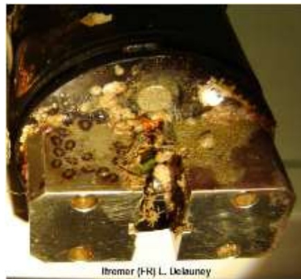
شکل ۵ - فلوئورومتر پس از ۳۰ روز در هلگولند (۱) (آلمان) در طول تابستان [۲۰].
