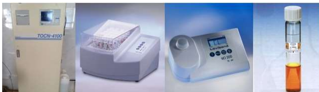
شکل ۲- دستگاه اندازه‌گیری COD از چپ به راست: دستگاه TOC، راکتور، فوتومتر و ویال.
