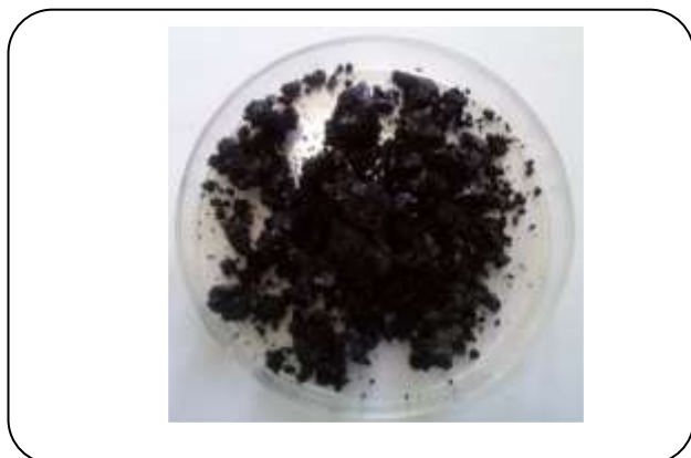
شکل ۱- نمونه کلوخه های آسفالتینی به دست آمده از سر چاه نفت.
