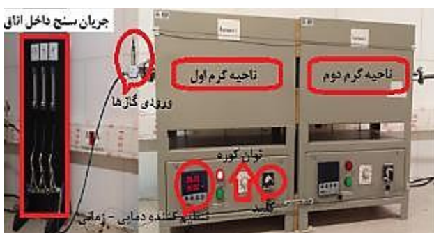
شکل ۵ - شمایی از دستگاه رسوب‌دهی شیمیایی بخار در فشار اتمسفری مورد استفاده
