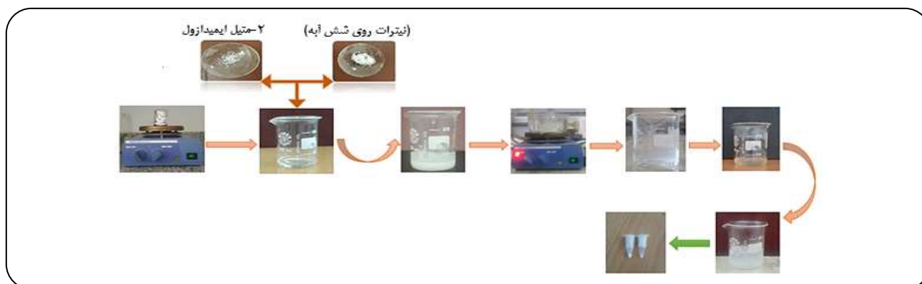
شکل ۳- مرحله‌های سنتز نانوذره‌های ZIF-8 با مایع‌های یونی.
