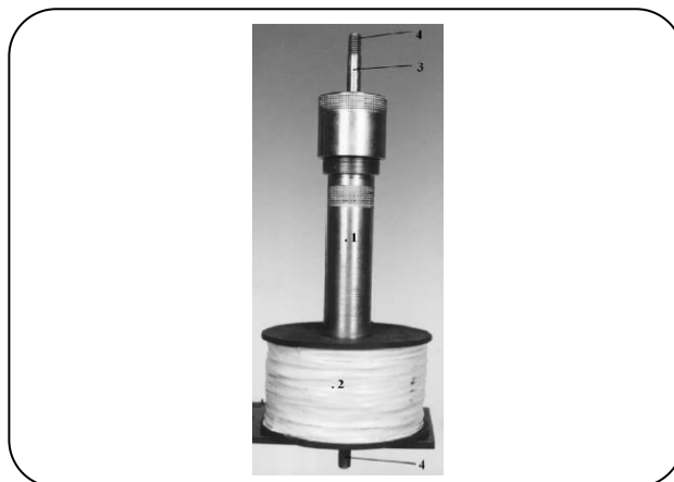
شکل ۷- دمپر با سوسپانسیون مگنتورئولوژیکال. ۱- بدنه دمپر، ۲- کویل، ۳- محور پیستون، ۴- اجزای سفت‌کننده [۷۳].
