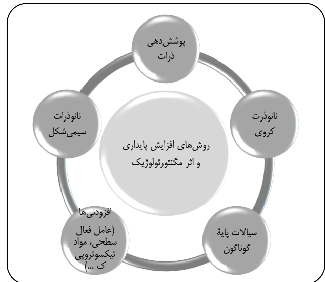
شکل ۳ - روش‌های پایدارسازی سیال‌های مگنتورئولوژیک [۳۶].
