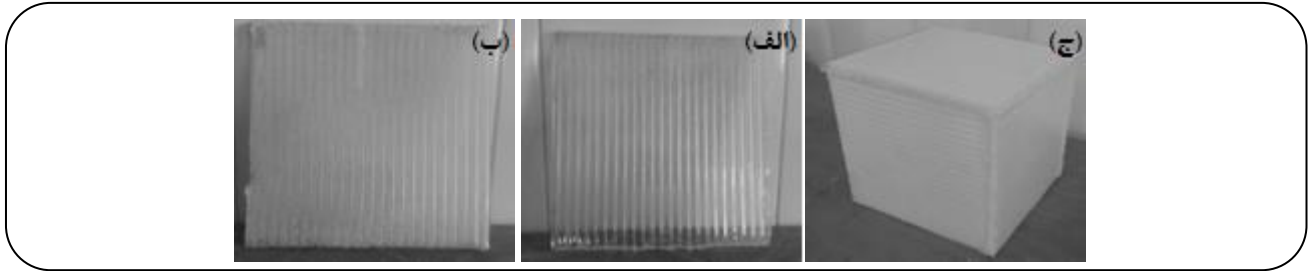
شکل ۱- الف) صفحه پلی کربنات خالی، ب) صفحه پلی کربنات پر شده با ایروژل، ج) نمونه محفظه ساخته شده برای آزمون‌های گرمایی.
