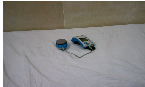
شکل ۱. دستگاه دینامومتر یا سنجش قدرت عضلات
