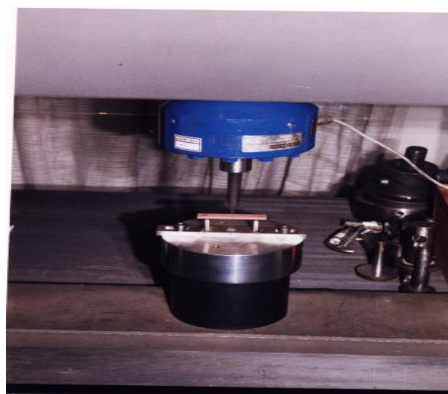
شکل ۲: اعمال نیرو توسط اینسترون بر روی نمونه
