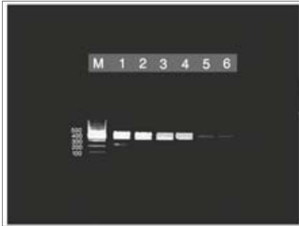
تصویر ۲- واکنش زنجیره ای پلی مرز حاصل از رقت سازی سلول باکتری. ستون M سایز مارکر DNA ladder plus 100bp ستون شماره ۱ غلظت ۱۰ ۰ - ستون شماره ۲ غلظت ۱۰ ۱ - ستون ۳ غلظت ۱۰ ۲ - ستون شماره ۴ غلظت ۱۰ ۳ - ستون شماره ۵ غلظت ۱۰ ۴ - ستون شماره ۶ غلظت ۱۰ ۵ .
