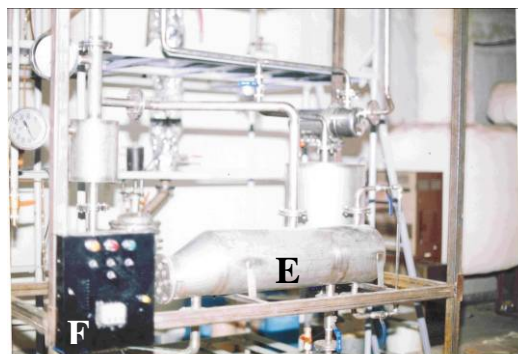
شکل ۴- تصویر از روبرو و قسمت پایین واحد تقطیر E- ریبویلر، F- جعبه الکتریکی کنترل بار حرارتی ریبویلر
