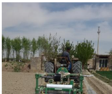
شکل ۱- کاشت با دستگاه کاشت توأم
