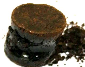
شکل ۲ - تصویری از آثرول آهن (III) اکسید قبل از کلسینه شدن
