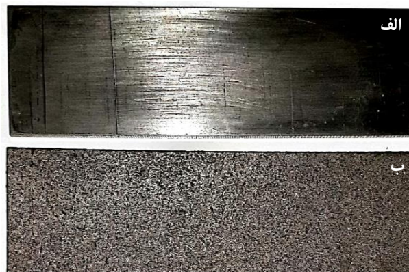
شکل ۱- صفحه استیل صیقل زده شده (الف) قبل از سند بلاست، (ب) صفحه بعد از سند بلاست
