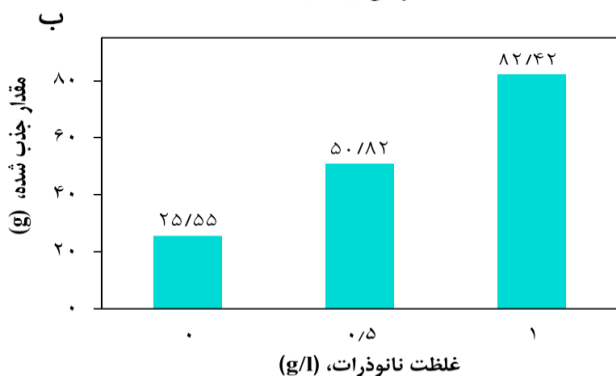
شکل ۵- نرخ جذب کربن دی‌اکسید در آب و نانوسیال در دمای ۳۵ °C و شدت جریان ۲۰۰ ml/min
