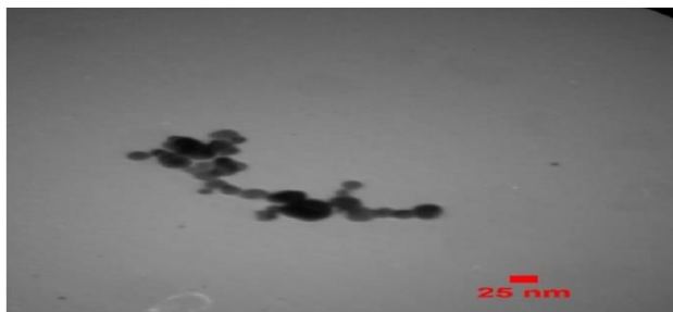
شکل ۱ - تصویر میکروسکوپ الکترونی عبوری نانوذره‌های اکسید نیکل
