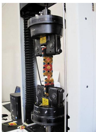
شکل ۴ - استحکام کششی بر روی نمونه‌ها
