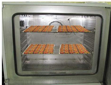
شکل ۱ - قرارگیری نمونه‌ها در رطوبت نسبی ۸۰ درصد در دستگاه Binder
