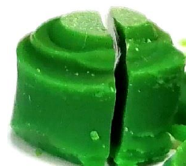
شکل ۳ - تصویری از آنروژل اکسید نیکل پیش از کلسینه شدن
