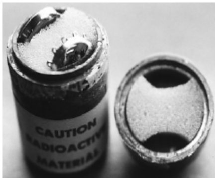
تصویر ۳- محفظه سربی حاوی پلاک چشمی رادیواکتیو
