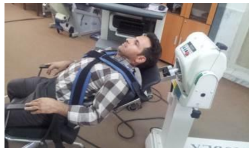
شکل ۲. نحوه قرار گرفتن داوطلب روی ابزار الحاقی طراحی شده جهت بایودکس مدل 4Pro برای اندازه‌گیری گشتاورهای چرخشی تنه
