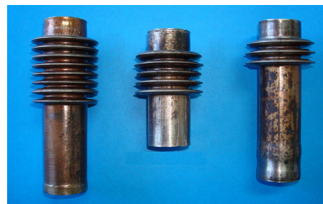
شکل ۱۴- به ترتیب از سمت راست، لوله‌های کنگره‌ای با سه، پنج و هشت کنگره شکل داده شده با روش آزمایشگاهی در قالب باز
