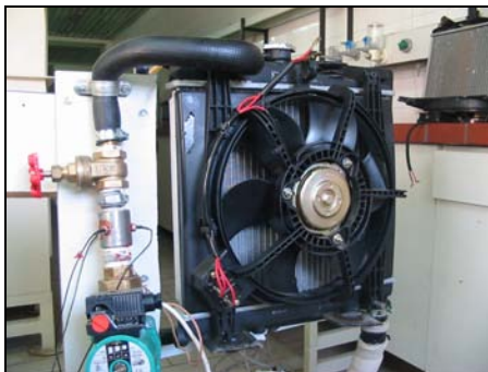
شکل ۴- فن نصب شده روی سکوی آزمون رادیاتور
