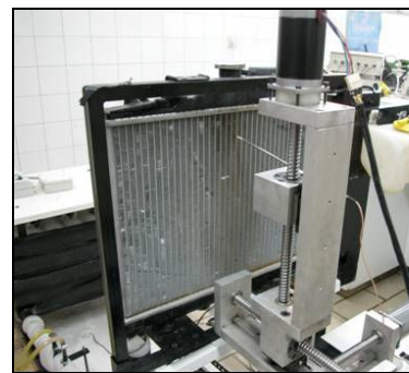
شکل ۵- مکانیزم انتقال دهنده و پراب سیم‌داغ پشت رادیاتور
