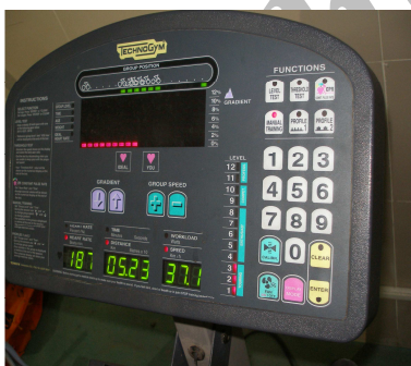
شکل ۱: دستگاه رکورد گیری جهت اندازه گیری سرعت، مسافت و ضربان قلب
