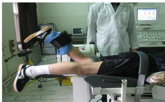
شکل ۳: نحوه اندازه‌گیری گشتاور فلکسوری مفصل زانو
