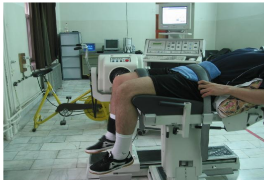
شکل ۲: نحوه اندازه‌گیری گشتاور اکستانسوری مفصل زانو
