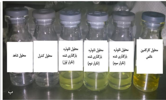
شکل ۲: انحلال نانوذرات در pH های ۵ (الف) و ۷ (ب)؛ به ازای هر pH، یک محلول شاهد (بدون باکتری)، یک محلول کنترل (بدون نانوذره)، یک محلول نانوذره (در حداقل غلظت بازدارندگی، با سه تکرار) و محلولی از کارکامین خالص (حاوی میانگین مقدار کارکامین در نانوذرات) در نظر گرفته شد.
