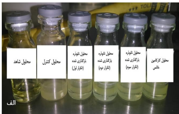
شکل ۲: انحلال نانوذرات در pH های ۵ (الف) و ۷ (ب)؛ به ازای هر pH، یک محلول شاهد (بدون باکتری)، یک محلول کنترل (بدون نانوذره)، یک محلول نانوذره (در حداقل غلظت بازدارندگی، با سه تکرار) و محلولی از کارکامین خالص (حاوی میانگین مقدار کارکامین در نانوذرات) در نظر گرفته شد.
