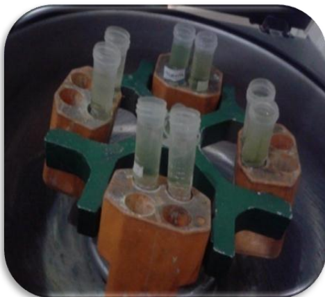
شکل ۴) سانتریفوژ جهت جدا کردن ریز جلبکها
