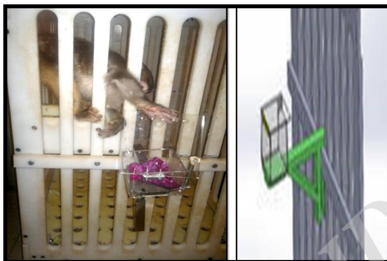
شکل ۳) باکس طراحی شده به منظور سنجش میزان یادگیری و حافظه بینایی و باز کردن درب ظرف و دست‌یابی به پاداش توسط میمون
