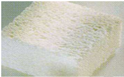
شکل ۴. بلوک هیدروکسی آپاتیت- تری کلسیم فسفات. این بلوک مکعبی شکل، به ابعاد 3 \times 3 \times 3 میلی‌متر می‌باشد
