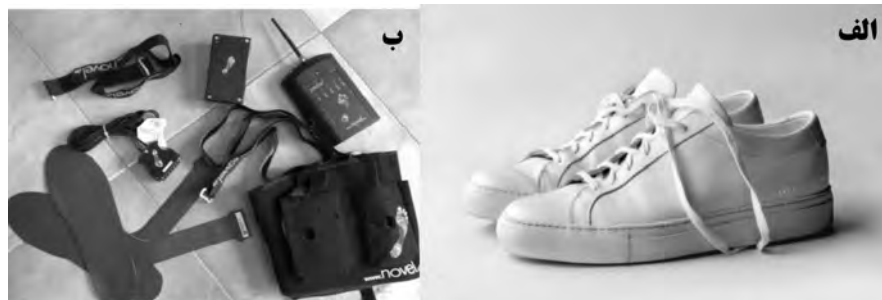
تصویر شماره ۱ الف) کفش استاندارد مورد استفاده در این تحقیق؛ ب) سیستم اندازه‌گیری توزیع فشار کف پای
