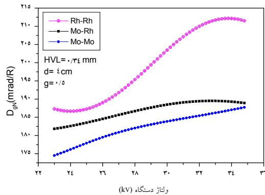
شکل ۱-۱: تغییرات متوسط دوز جذبی غده‌ای بر حسب ولتاژ لامپ اشعه X دستگاه ماموگرام برای سه آرایش هدف - فیلتر و به ازای kV=۰/۳۴ mm، d=۴ cm، HVL=۰/۳۴ mm، و G=۰/۵.
