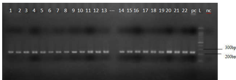
شکل ۱: الکتروفورز محصول PCR ژن GAPDH نمونه‌های بافت پولیپ آدنوماتوز بر روی ژل آگارز ۱/۵٪. چاهک‌های ۱ تا ۲۲: محصول PCR از cDNA بافت پولیپ آدنوماتوز افراد بیمار، چاهک ۱: مارکر 100bp (:#SM0321)، چاهک‌های pc: کنترل مثبت، چاهک nc: کنترل منفی. قطعه باند مورد نظر ۲۳۶ جفت باز می‌باشد. (در چاهک‌هایی که با علامت - نشان داده شده، نمونه‌های الکتروفورز نشده است).
