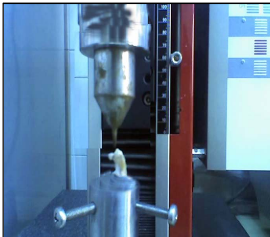
شکل ۱- انجام تست Cantilever bending بر روی فمور
