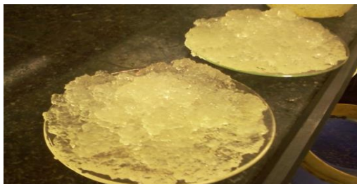
شکل ۳. تصاویر هیدروژل‌های متورم ساخته شده با فراصوت (راست) و نمونه خشک پودری (چپ)
