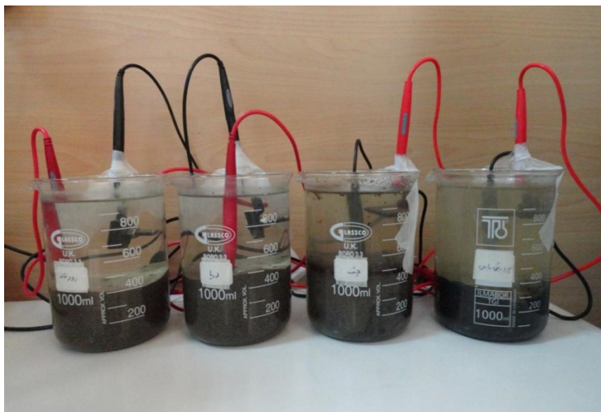
شکل ۱. پیل‌های سوختی رسوبی راه اندازی شده با ۴ اکوسیستم مختلف در آزمایشگاه
