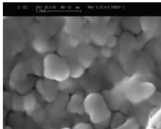
شکل ۱۱: تصویر میکروسکوپ الکترونی روبشی از SiC سینتر شده پس از اچ.
