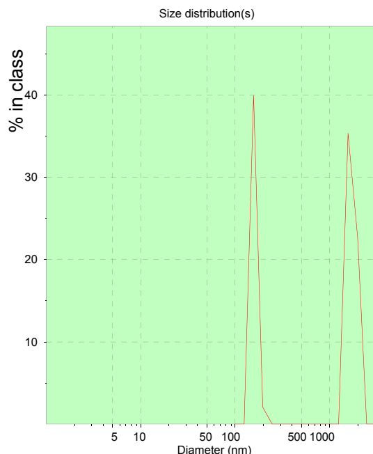
شکل ۶: توزیع اندازه ذرات پودر هیدروکسی آپاتیت که به مدت ۲۰ ساعت آسیاب شده است.
