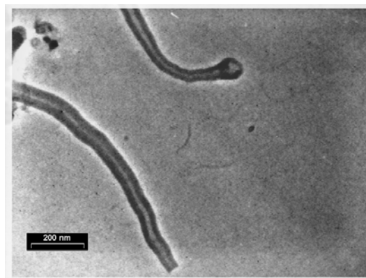
شکل ۳: تصاویر TEM از نانوتیوب‌های کربنی بدست آمده از فرآیند CVD بزرگنمایی مختلف.
